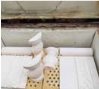
مرحله پخت بدنه Firing the body
