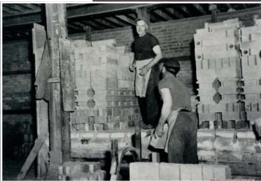
Figure 210 Manutention de briques réfractaires à l'usine Belref. © Musée de la céramique d'Andenne
