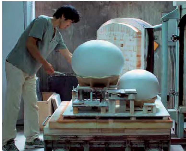
Caricamento del forno Kiln loading
