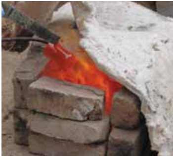
یک کوره ساده برای راکو و ساخت فریت A simple kiln for making raku and frit
