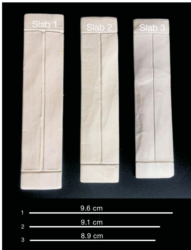
Fig. 2: Slab 1:1 150 °C, Slab 2:1 250 °C & Slab 3:1 300 °C respectively.
