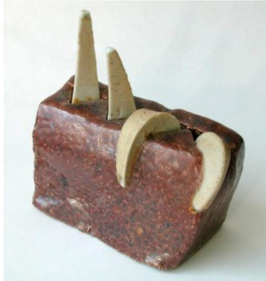
Conos pirométricos (foto Wikipedia). Puede comprobarse la mala colocación de los conos, que han caído en diferentes direcciones, debido a una colocación vertical
