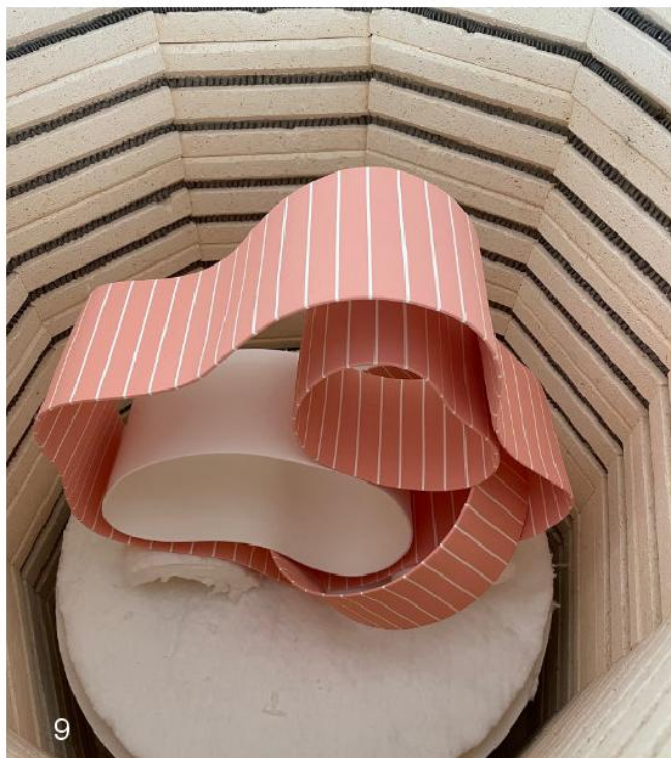
9. Na het plaatsen van het vierde element, volgt de stook op 1240 °C.
