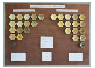
ผลการทดลองพัฒนาสีเคลือบชุดที่ 2 เผาที่ระดับอุณหภูมิ 1220 และ 1250 องศาเซลเซียส บรรยากาศออกซิเดชัน ผลการทดลองพัฒนาสีเคลือบชุดที่ 3 เผาที่ระดับอุณหภูมิ 1220 และ 1250 องศาเซลเซียส บรรยากาศออกซิเดชัน
