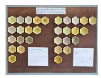
ผลการทดลองพัฒนาสีเคลือบชุดที่ 4 เผาที่ระดับอณหภมิ 1220 องศาเซลเซียส บรรยากาศออกซิเดชัน
