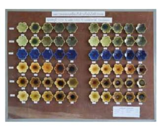
ผลการทดลองพัฒนาสีเคลือบชุดที่ 1 เผาที่ระดับอุณหภูมิ 1220 และ 1250 องศาเซลเซียส บรรยากาศออกซิเดชัน
