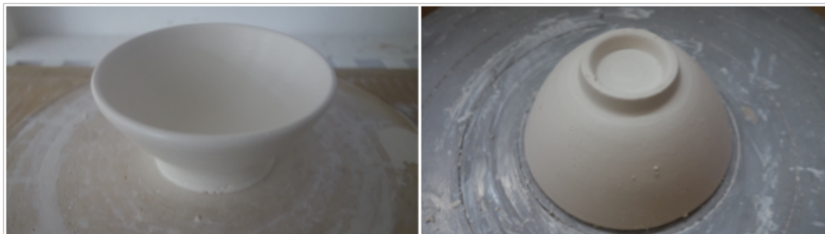
Figura 46 - Peça de porcelana fosfática com 4 % de bentonita conformada no torno elétrico (à direita) e acabamento feito no ponto de couro (à esquerda).
