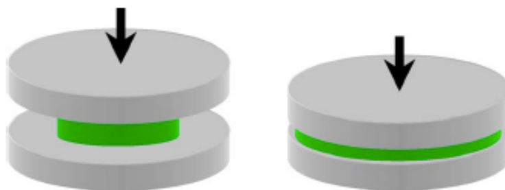
Figura 20 - Configuração de volume constante do corpo de prova durante todo ensaio
