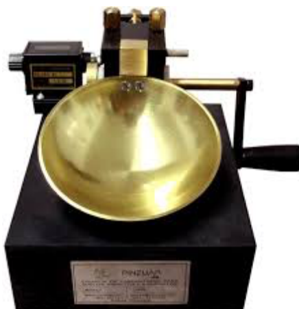
Figura 15 - Aparato de Casagrande para ensaio de limite líquido pelo método de Atterberg.
