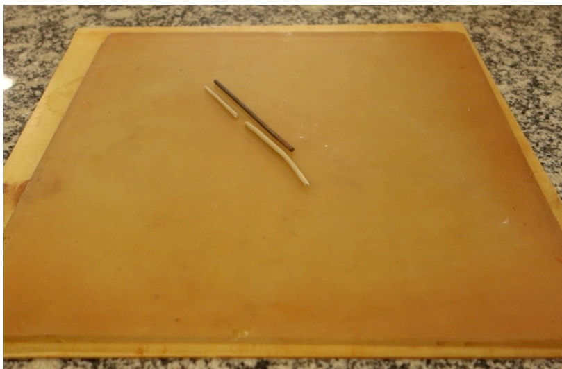
Figura 24 - Equipamento do ensaio de limite plástico, (1) placa de vidro esmerilhada, (2) gabarito cilíndrico de diâmetro 3 mm e comprimento 100 mm.
