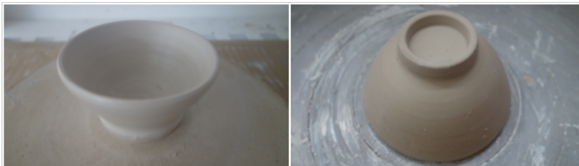
Figura 44 - Peça de Porcelana 905 conformada no torno elétrico (à direita) e acabamento feito no ponto de couro (à esquerda).
