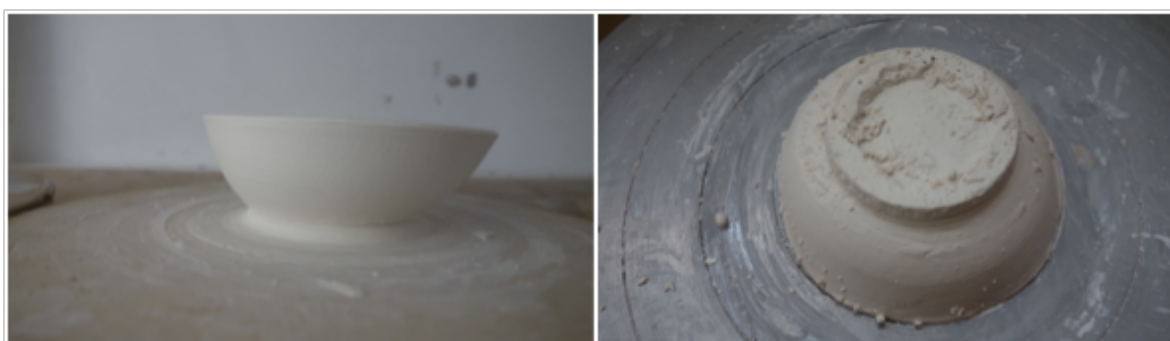
Figura 45 - Peça de porcelana fosfática conformada no torno elétrico (à direita) e acabamento feito no ponto de couro (à esquerda).
