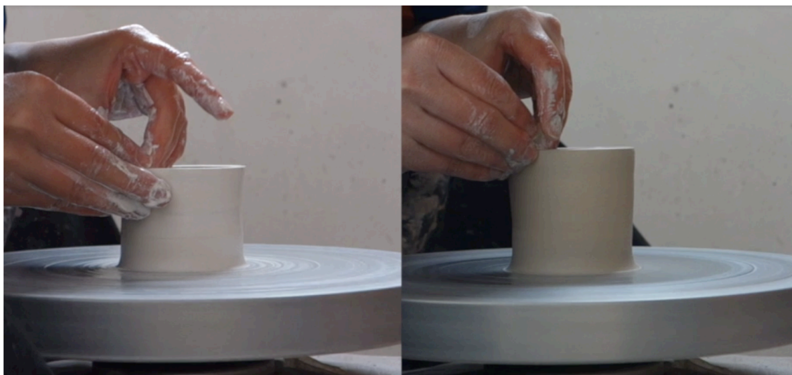
Figura 51 - Comparação das massas cerâmicas, à direita porcelana fosfática com 4 % de bentonita e à esquerda Porcelana 905 durante processo de subida da massa.
