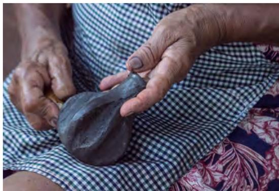
El modelado en La Chamba se realiza a partir de placas extendidas y moldes, los cuales constituyen la base del recipiente, que posteriormente se concluye integrando rollos de arcilla, una vez que el barro está templado o en estado de cuero. Esta técnica no es de dominio común en el sector y actualmente se ha disminuido en gran medida el número de personas que la pueden ejercer, evidenciando un panorama crítico para la tradición ancestral y las generaciones venideras.
