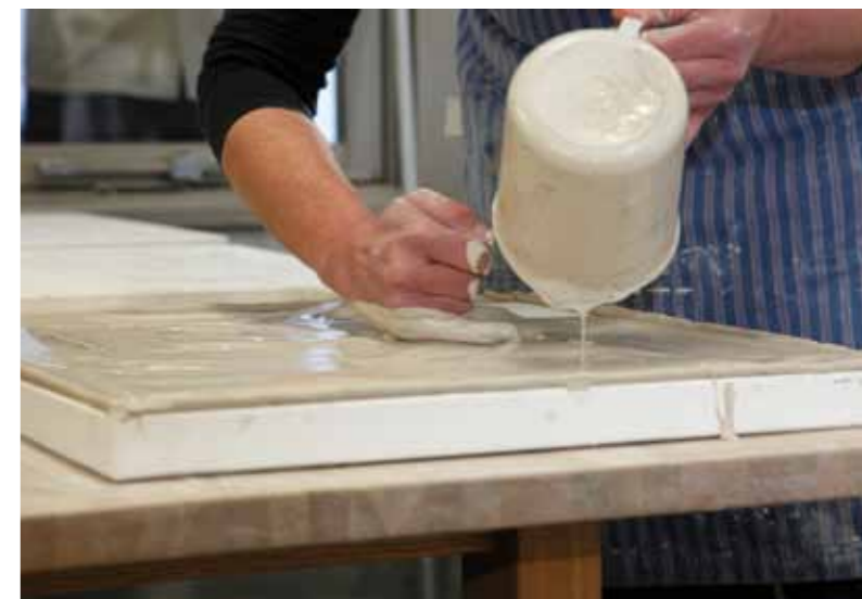
Le sculture in porcellana sono create utilizzando la tecnica di colaggio in stampi - Using porcelain slip-casting material for the sculptures
