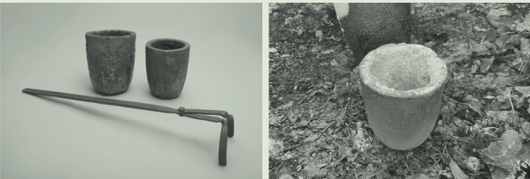
<흑연도가니>, 국가무형문화재 유기장 보유자 이봉주 도구, 20세기, 대구방재유기박물관 / 아연-동 합금액을 거꾸집에 부은 후 열이 남아 있는 도가니, 국가무형문화재 두석장 보유자 박문열 도구, 2020년 ©연구자 김세린 촬영
