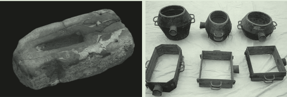
<창(槌) 축을 만들기 위한 청동기 시대 거꾸집>, 청동기시대, 에스타비아어 역사박물관 ©Rama(wikipedia.org) / <주물유기 거꾸집(항남틀)>, 국가무형문화재 유기장 보유자 이봉주 도구, 20세기 ©국립무형유산원
