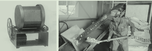
금속공예가 전용일의 금속공예용 <볼밀(텀블러)>, 20세기 / <도자기 태토 가공할 때 볼밀을 사용하는 장면>, 21세기, 양구백자박물관 ©한국공예디자인문화진흥원
