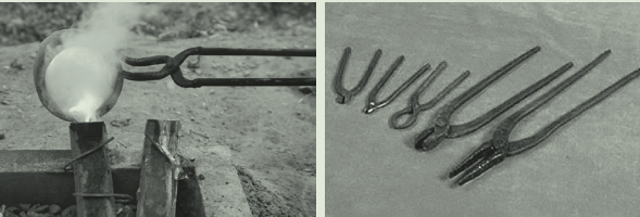
집게로 도가니를 잡아 쇳물을 붓는 장면, 국가무형문화재 두석장 보유자 박문열 작업, 21세기 ©국립무형유산원 / <국가무형문화재 장도장 분야에서 사용하는 각종 물줄이(집게)>, 국가무형문화재 장도장 보유자故박용기 도구, 20세기 ©국립무형유산원
