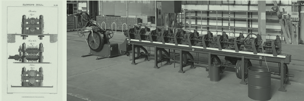
1813년 초기 <압연기 고안 설계도> ©John Mason Good(wikipedia.org) / Laminatoio Properzi, <다빈치가 고안했던 압연기를 추정 재현한 압연기>, 이탈리아 밀라노 ©Alessandro Nassiri per Museo scienza e tecnologia Milano(wikipedia.org)
