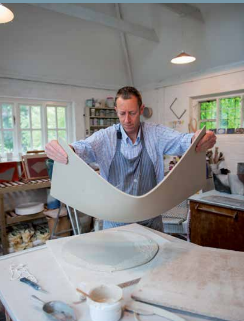
La lastra di argilla stesa viene sollevata Lifting up rolled slab of clay
