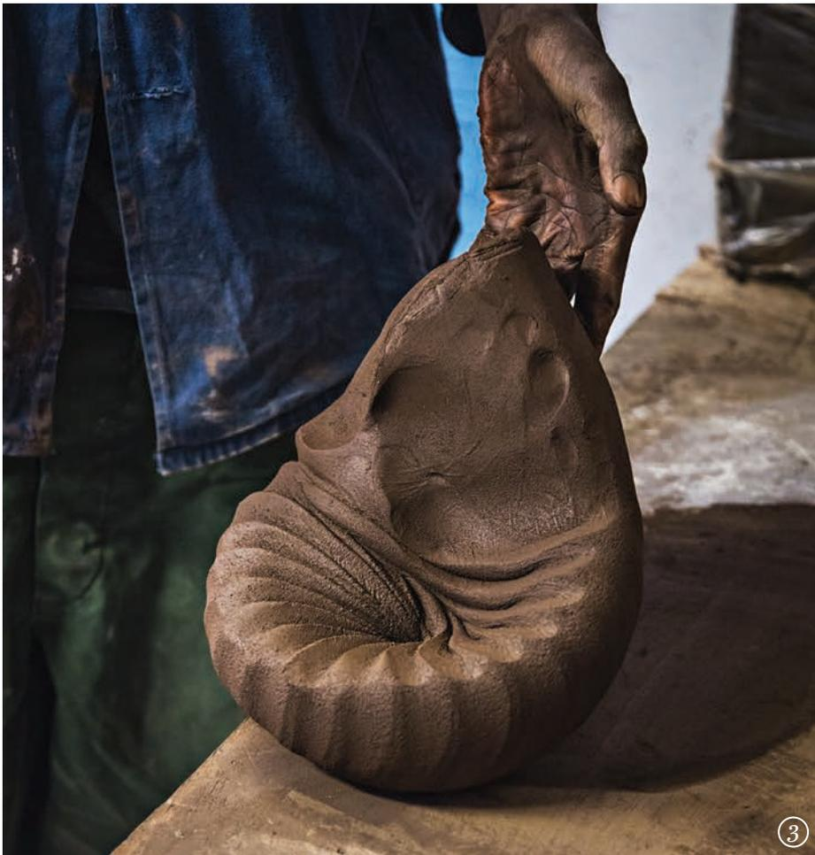
▼ King superpose les tranches de deux argiles différentes sur une balance ①, avant de les malaxer à la main ② façon Kikuneri (« malaxage en forme de chrysanthème ») ③ : une technique de préparation de l'argile par pétrissage circulaire avec les deux mains, afin d'extraire de la terre fraîche les éventuelles bulles d'air qui pourraient briser la pièce à la cuisson.
