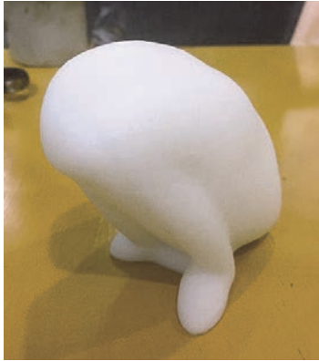
写真19 表面を仕上げたABS樹脂原形
