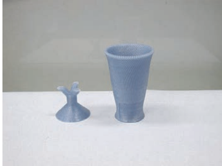
写真10 3Dプリンティングによる原型
