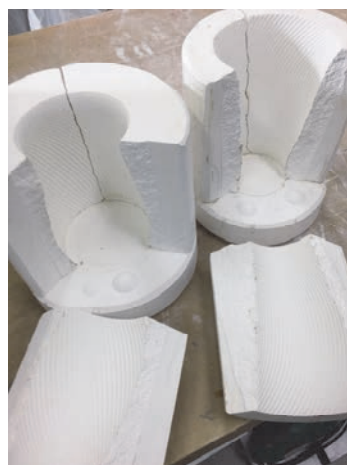
(写真5) 泥漿鑄込み用石膏型
