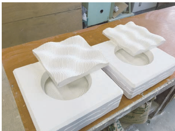
(写真5) 石膏原型と鋳込み用石膏型
