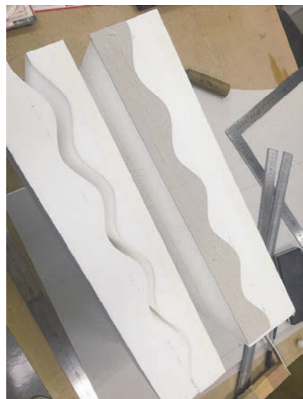
(写真3) 発泡スチロールのニクロム線ヒートカッターでの切断
