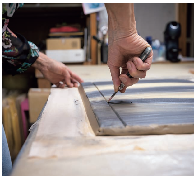
切り口を斜めにして、土の板を切る。
