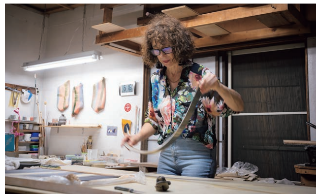
帯の両端を手で持って、上から下に何度も落とす。初めはこれくらいの長さ。
