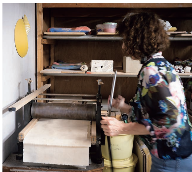
両端に12ミリの角材を置いて土をプレスし、厚みを揃える。
